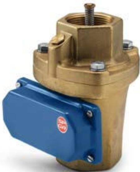
Le contacteur de débit SP-GA est conçu pour donner une alarme à très faible débit tout en permettant un débit de passage très important une fois que la pompe ou la vanne a été activée par le microswitch. La fonction est basée uniquement sur la technologie de section variable utilisée et n'est donc pas affectée par les changements de pression statique.
