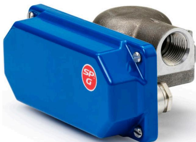
Notre contacteur de débit SP-G est conçu pour s'adapter aux petits débits et aux petites tailles de canalisations. Il fonctionne sur le principe de la section de passage variable où le point de commutation de l'alarme peut être réglé sur un débit très faible et le contacteur est toujours capable de gérer des débits importants sans créer de chute de pression importante.
